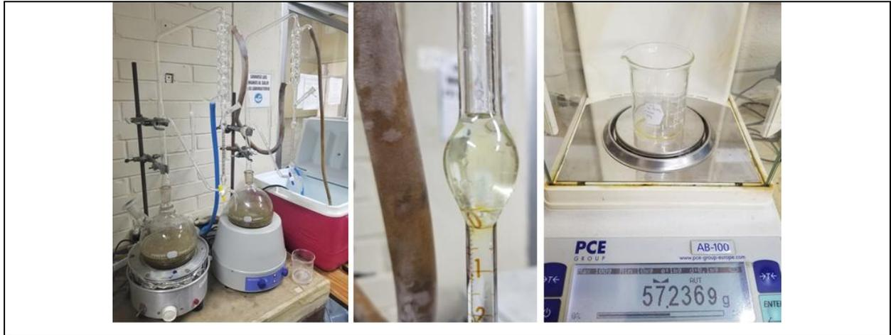
Figura 6: Proceso de extracción de aceite esencial técnica de hidrodestilación y cálculo del rendimiento.
