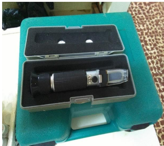
Refractómetro para medir la salinidad de agua
