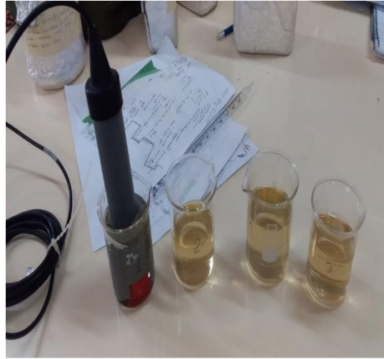
Medición del PH de la muestra
