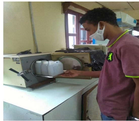
Autoclave sirve para esterilizar los recipientes de laboratorio
